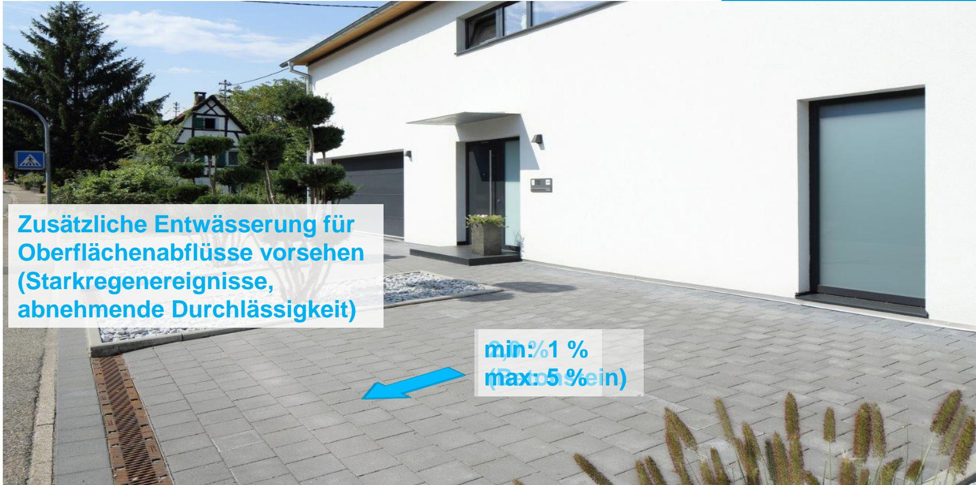
Zusätzliche Entwässerung für Oberflächenabflüsse vorsehen (Starkregenereignisse, abnehmende Durchlässigkeit)
